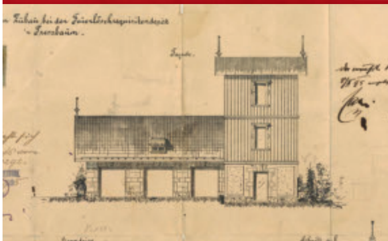
Abb. H-3: Plan für die Erweiterung des alten Feuerstadls mit Steigerturm durch einen Anbau mit drei Fahrzeugstellplätzen (Plandatum 26.10.1895) (Architekt Franz Kachler, Wien)
