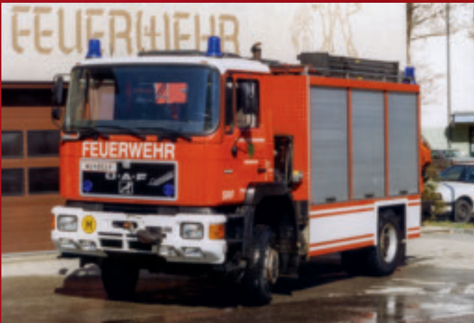
Abb. F-16: Schweres Rüstfahrzeug mit Bergekran und Seilwinde (Baujahr 1990)
