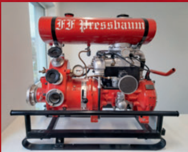
Abb. F-5: Tragkraftspritze mit DKW-Motor vom alten Aggregat aus dem Jahr 1931 und dem Pumpenteil aus dem Jahr 1947 im heutigen Zustand
