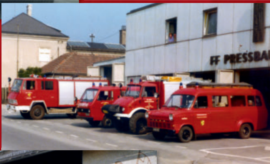
Abb. F-19: Fahrzeugbestand der FF Pressbaum im Jahr 1978 (von links nach rechts: Tanklöschfahrzeug TLF 4000, Kommandofahrzeug, Rüstfahrzeug, Öleinsatzfahrzeug)
