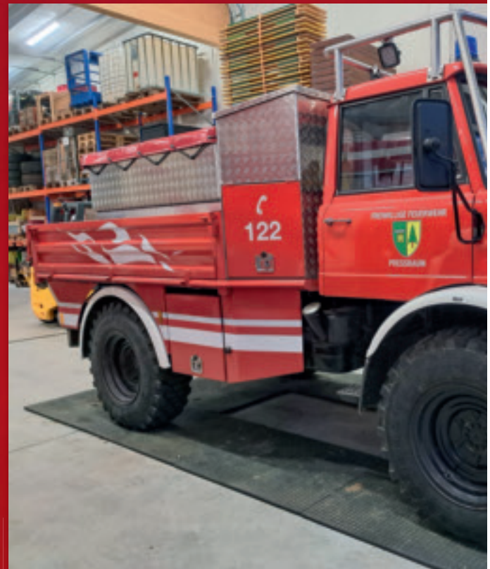
Abb. F-15: Unimog nach Umbau in ein Waldbrandlöschfahrzeug (Baujahr 1976) (Bauzustand 2023)
