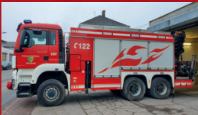
Abb. F-17: Schweres Rüstfahrzeug mit Bergekran und Seilwinde (Baujahr 2000)
